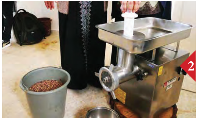
عملية فرم ثمار الصنوبر بواسطة آلة فرم اللحم الكهربائية
