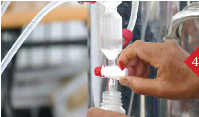
بعد عدة ساعات يفصل الماء المقطر عن الزيت الأساسي
